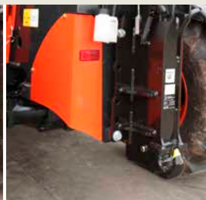
Hydraulisch Anhängerkupplung mit hydraulischer Verriegelung
