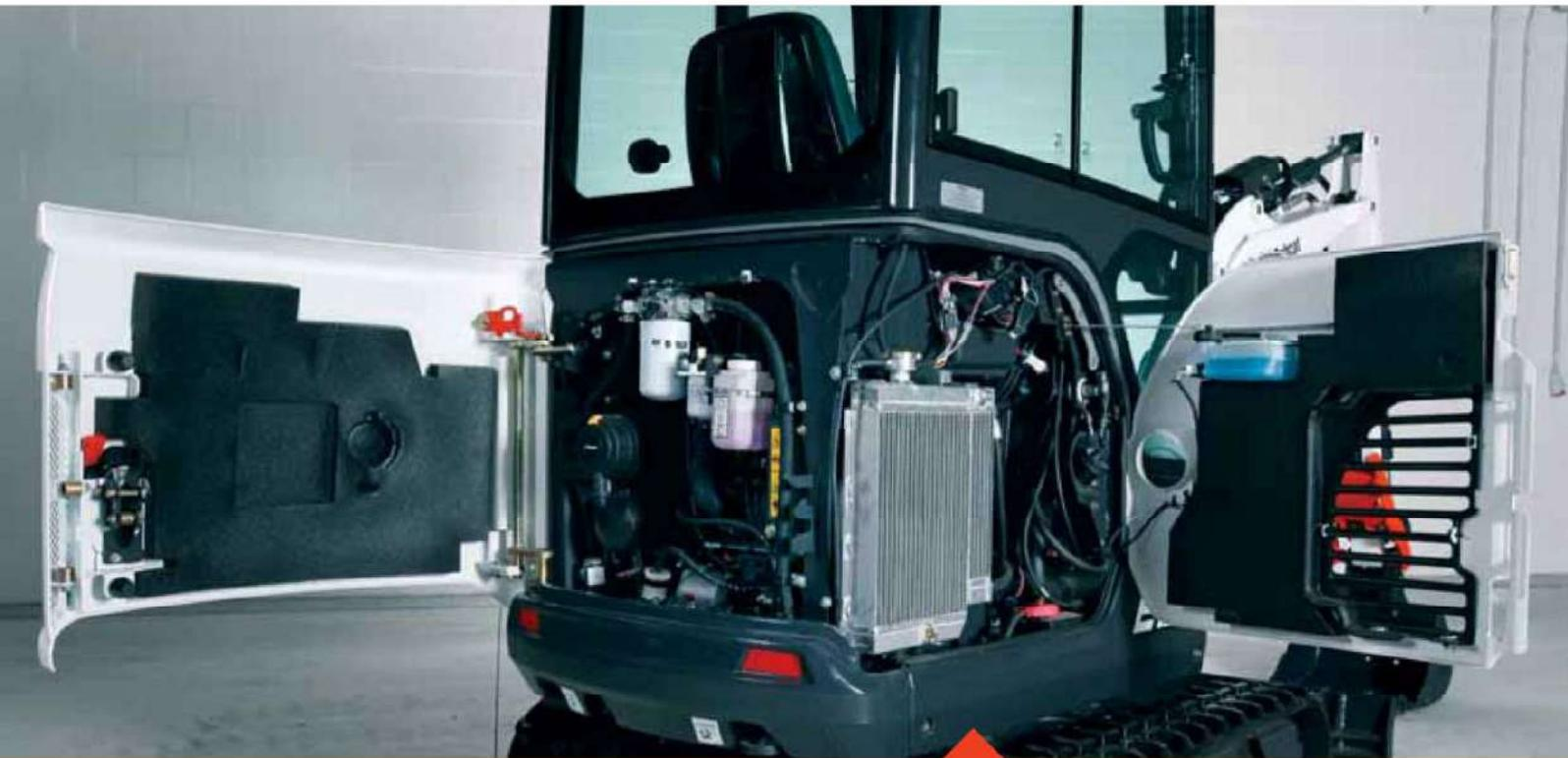
Nebeneinander angeordnete Kühler erleichtern die Reinigung. Fehlercodes werden auf der Bedienkonsole und dem angeschlossenen Service-Tool angezeigt und erleichtern so die Diagnose. Die Heckklappe des E20 sorgt für einen hervorragenden Zugang zu allen Wartungs- und Instandhaltungspunkten.
